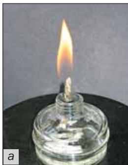
Мал. 13. Пристрої для нагрівання: а — спиртівка; б — гасіння полум'я ковпачком; в — газовий пальник
