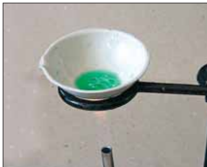
Мал. 21. Нагрівання рідини в порцеляновій чашці
