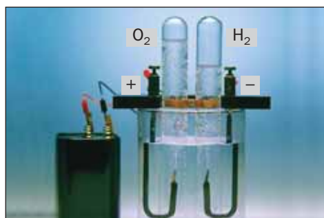
Мал. 75. Розклад води постійним електричним струмом
