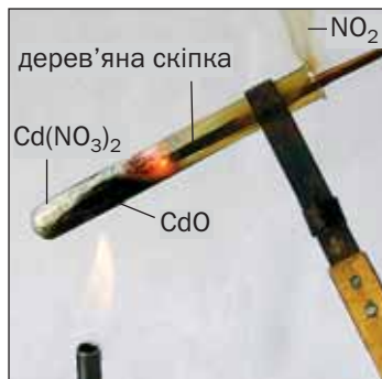
Мал. 57. Розкладання речовини під час нагрівання
