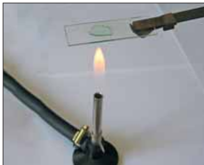
Мал. 22. Випарювання рідини на предметному склі
