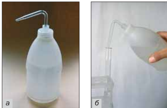
Мал. 9. Промивалка (а) і користування нею (б)
