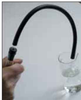
Мал. 59. Перевірка приладу на герметичність
